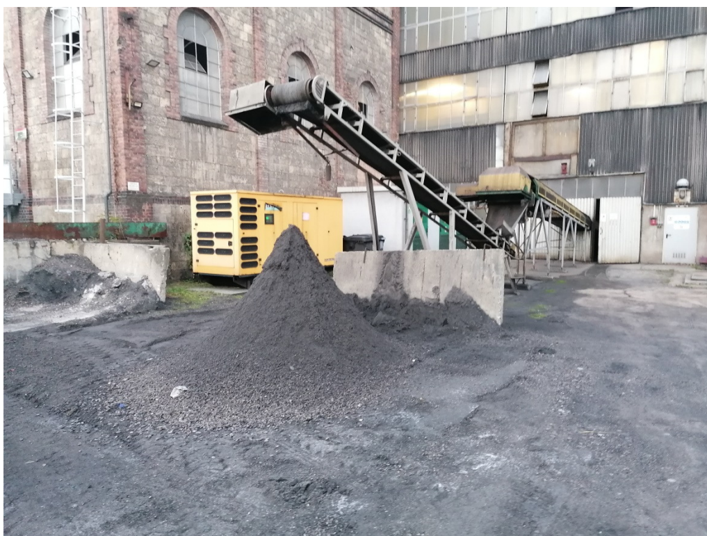
Fot.2.Widok istniejącego boksu magazynowego żużla oraz taśmociągu odstawy żużla
